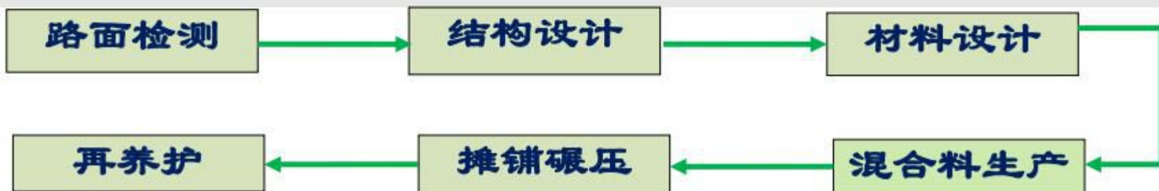
沥青路面大修工程流程
